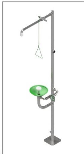
Комбинированный аварийный душ для установки в помещении с креплением к полу. В комплекте с фонтаном для глаз/лица. Материал исполнения - оцинкованная сталь. Толщина трубного металла более 3мм. По запросу возможно исполнение из нержавеющей стали марки AISI 304/316.
