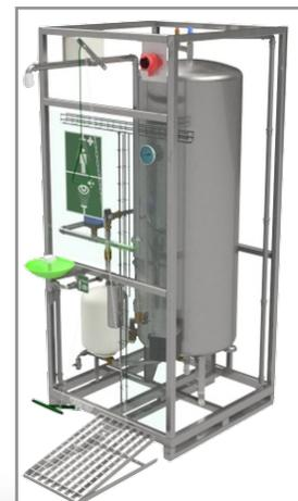
В кабине установлен аварийный душ для тела, фонтан для глаз/лица, бак запаса горячей воды и оборудование для поддержания давления и качества входящей воды, которая нагревается погружным электро-нагревателем до 65-80С в баке из нержавеющей стали. При активации аварийного душа горячая вода из бака смешивается с холодной водой из водопровода с помощью термостатического смесительного клапана с защитой от ожога.
