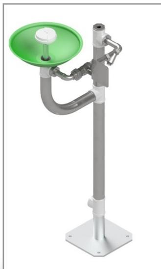
Аварийный фонтан для глаз/лица с креплением к полу выполнен из оцинкованной стали. Раковина, фиттинги и ответственные узлы выполнены из нержавеющей стали. Толщина трубного металла - более 3 мм. Требуется самостоятельная сборка. Крепеж в комплект не входит.
