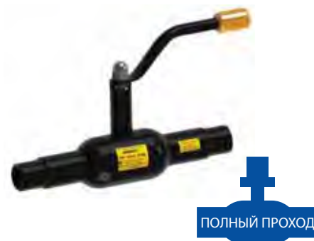
КШГ Серия 15, DN 15–40, PN 4,0 МПа Сварка / Сварка
