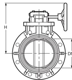
**Дисковый затвор 3800, монтаж между фланцами DIN,
